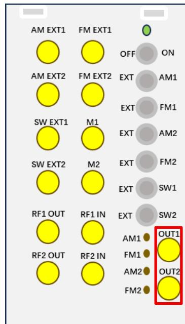
OUT1 与 OUT2 分别是通道 1 和通道 2 的射频信号输出，将此信号通过射频连接线
