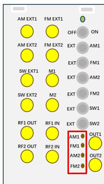
当选择使用内部调制时，此时所对应的功能的钮子开关应拨动至右侧，通过旋转上图所示滑
