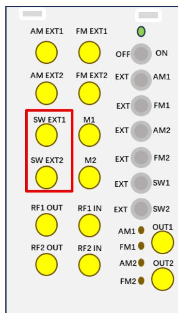
如上图所示，射频输出开关控制功能由钮子开关和 SMA 信号输入端子实现。当对应的射频连接端子未接任何信号（悬空）时，通过拨动钮子开关便可实现手动开关射频信号输出功能（往右开、往左关）；当要选择使用外部信号控制射频开关时，将所对应通道的钮子开关拨动至“EXT”侧，此时便可通过对应的 SMA 射频端子输出 TTL 信号来控制射频信号开断（H=开启, L=关闭）。
