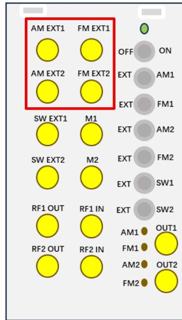
当选择使用外部调制时，此时所对应的功能的钮子开关应拨动至左侧，上图所示。SMA 射频连接端子应连接至外部电压输出端口，通过改变外部控制电压值，来实现对相应通道的频率或幅度调制，当电压保持稳定时，输出保持稳定。
