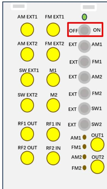
本设备通过机箱背部品字插头，220V/50Hz 市电供电，按下品字插头开关，设备上电。将上图所示前面板上钮子开关向左拨动至“ON”侧，绿色电源灯亮起，对应模块开始工作。
