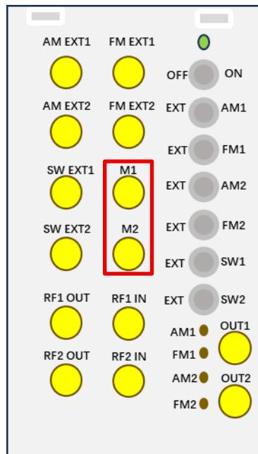
如上图所示，每个通道各提供了一个射频频率输出监测口，可实时监测相应通道的射频输出频率，通过射频连接线连接至频谱仪或示波器便可进行实时监测。
