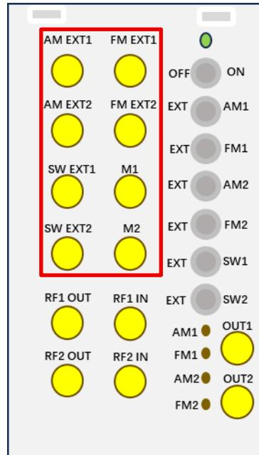
如上图所示，调制部分一共由两部分组成：一部分是由钮子开关控制，负责切换调制源（开关向右拨动是选择内部调制源，向左则选择外部）；一部分由 SMA 射频连接端子控制，当所对应的功能钮子开关拨至左侧（选择外部调制源 EXT），可通过由 SMA 射频端子输入调制电压对输出信号进行幅度（AM）或频率（FM）调制。
