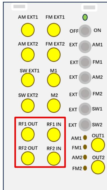
如上图所示，每个通道将各自的内部信号源输出与功放信号源输入接口连接至面板，出厂时所对应的通道均使用射频连接线进行短接，若用户想使用自己的信号源，可将短接的射频线拆下，将外部信号源连接至 RFxIN 端口，此时除 FM 功能不可用外，其他功能均正常。注意：外接信号源功率≤5dBm。
